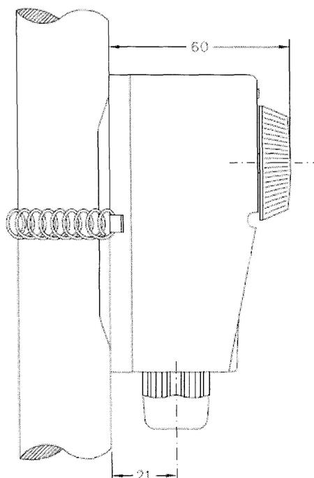
TUSC è un termostato in custodia unipolare, ad espansione di liquido, con contatti in commutazione; completo di passacavo.
